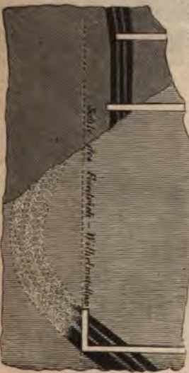
Profil durch den Wilhelmschacht und den Augustenschacht.
